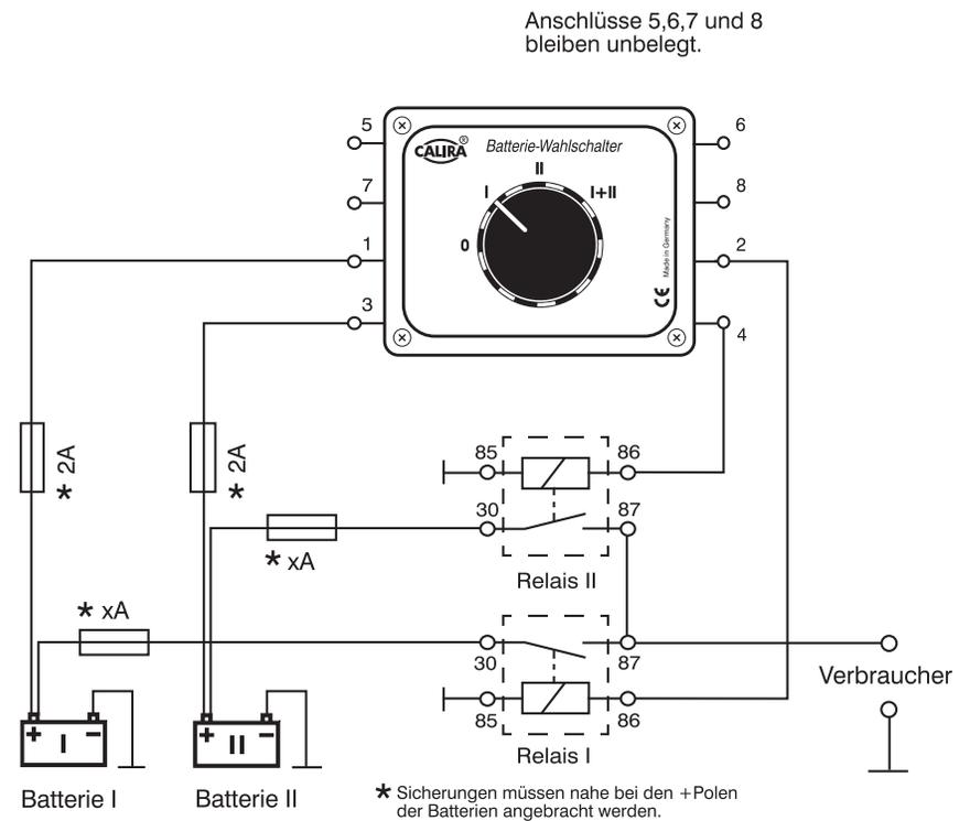
Hochleistungs-Trennrelais, Art.-Nr. H10 432 0070 00, belastbar bis 70A, verwenden.
