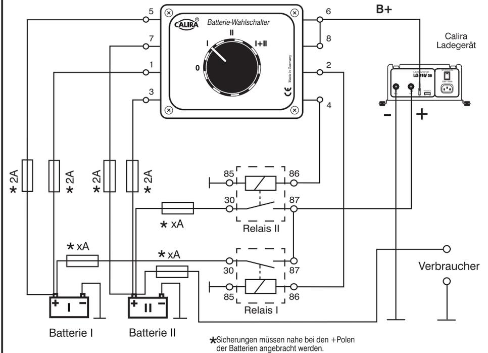
Hochleistungs-Trennrelais, Art.-Nr. H10 432 0070 00, belastbar bis 70A, verwenden.
